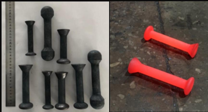
Стержни керамических высоковольтных изоляторов ЛЭП
