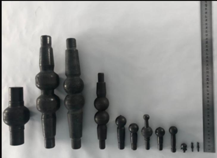
Прокатка заготовок с минимальными припусками под металлообработку или горячую штамповку
