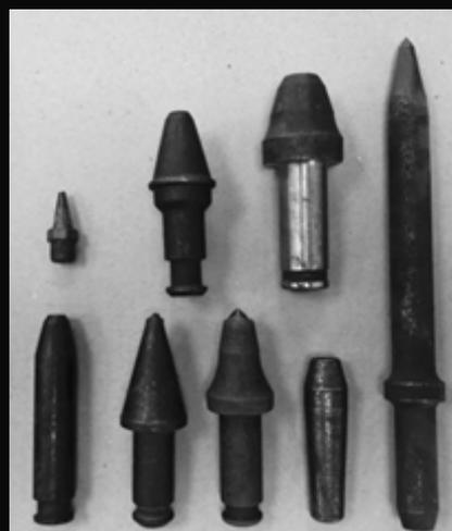
Корпусы горных резцов для проходческих комбайнов и дорожных фрез, пики отбойных молотков
