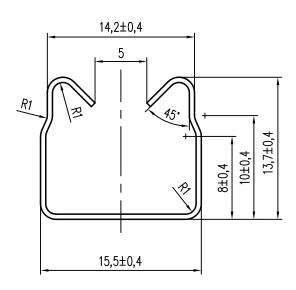
1. Материал сталь OU  $\frac{6-\Pi H\ \Gamma OCT\ 19904}{08\ BF\ \Gamma OCT\ 14918}$ ; OU  $\frac{6-\Pi H\ \Gamma OCT\ 19904}{08nc\ BF\ \Gamma OCT\ 14918}$ ; OU  $\frac{6-\Pi H\ \Gamma OCT\ 19904}{08nb\ BF\ \Gamma OCT\ 14918}$  (эти же стали с покрытием ПЭ).
