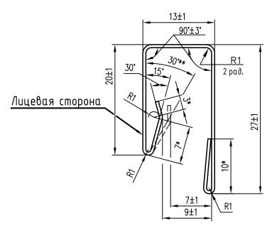
1. Материал: штрипс из холоднокатанной горячеоцинкованной стали и стали с лакокрасочным и полимерным покрытиями:
