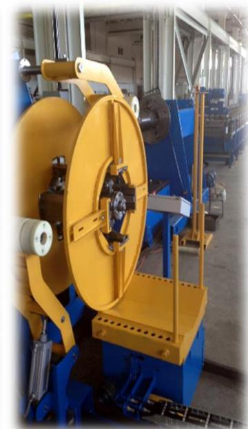
Высоконагруженная линейка рулоноразматывателей, предназначенных для наиболее производительных комплексов профилирования. Степень автоматизации загрузкой, выгрузкой рулонов максимальная.
