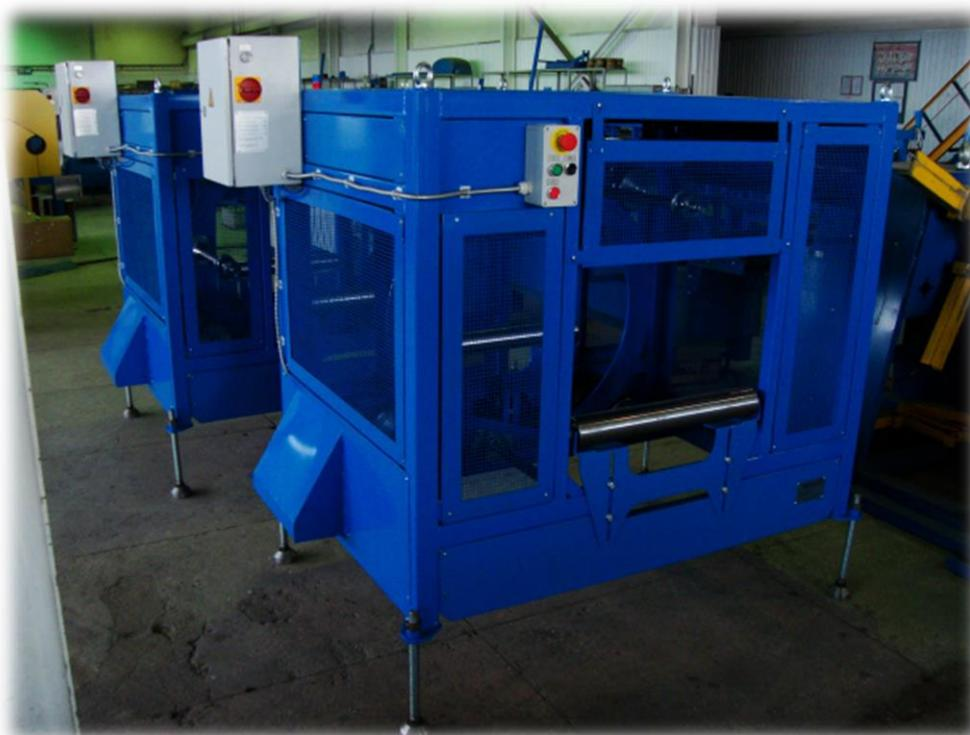
Крепление полимерной пленки к упаковываемому изделию и отрезка пленки от изделия после завершения операций по упаковке производится оператором машины вручную. Машина применяется для совместной работы с транспортерами при скоростях транспортировки упаковываемых изделий до 5 м/мин.
